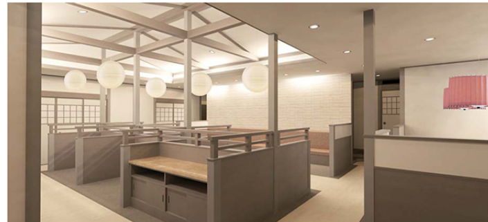
(図V) BIMによる内観パース 照明位置も落としこんであれば内観パースも簡単に用意できる。
