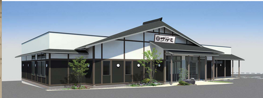
(図IV) BIMによる外観パース 3Dで設計が進むため実施設計中も常に3D透視図やアクセシビリティにて納まりや色彩を確認しながら作業を進めることができる。REVIT、ArchiCAD共BIMソフトのレンダリングは早くて美しい。
