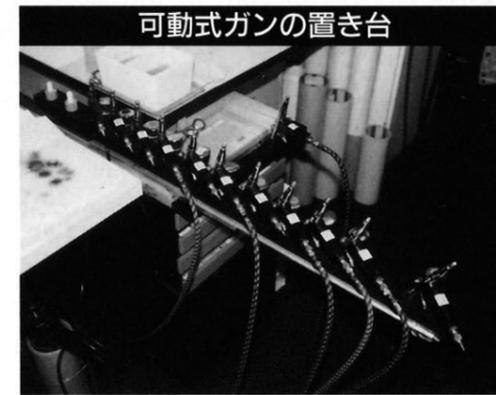
吹き付け作業の能率をよくするために考えたされた物で、本体、下部に引き出し用のレール金具をつけて、機の横に設置して使う時だけ、手前に引き出す仕組みです。絵具はウォーターカラーを使用しているため、時々、水を補充するだけで、固まる事はありません。空気を送るホースはワンタッチで取り換えられる物を使用しています。常時、使う色を入れてありガンの絵具を入れる所のフタの上、使う色が塗ってあります。
